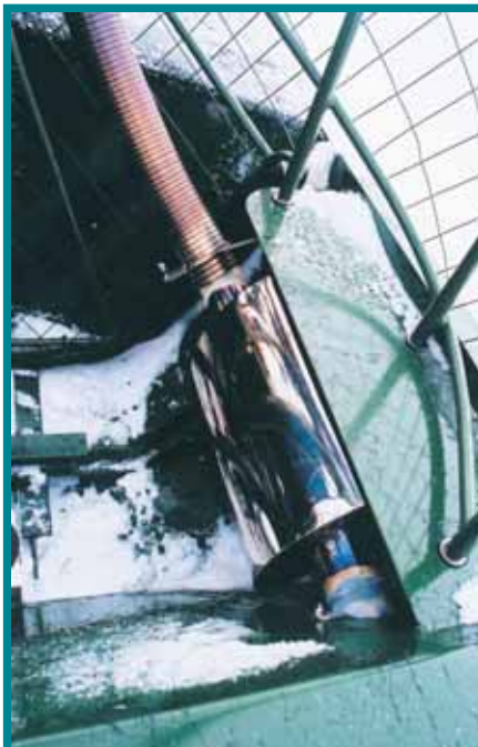
Выхлопные трубы и глушители — из нержавеющей стали
