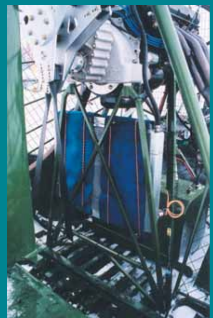
Огромный, рассчитанный на жару радиатор на морозе прикрыли кусками ковровина
