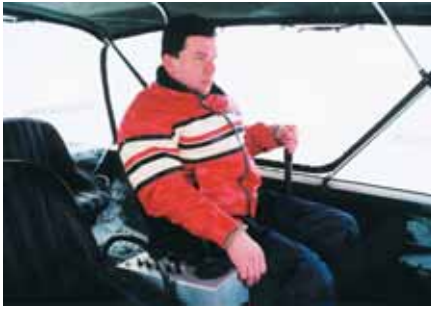
Оборудование интерьера — более чем спартанское. Из органов управления — только ручка воздушных рулей и педаль газа.
