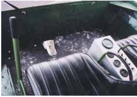
Оборудование интерьера — более чем спартанское. Из органов управления — только ручка воздушных рулей и педаль газа.
