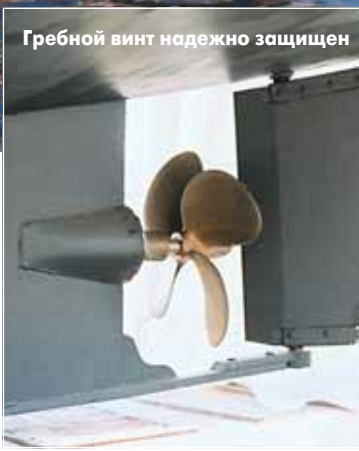
Подруливающее устройство (bowthruster) в носовой части корпуса
