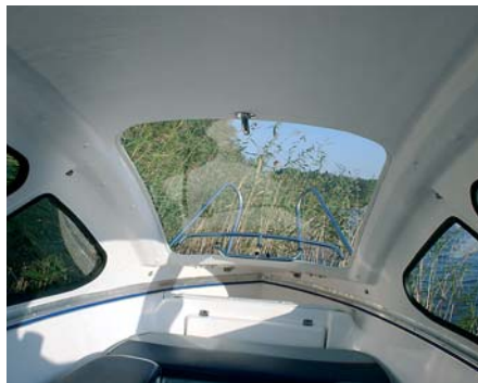
Передняя стойка ограничивает обзор водителя
