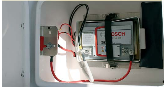
Для жесткого крепления аккумулятора на ходу удобно использовать резиновые хомуты от «Жигулей»
