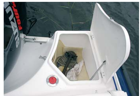
Крышка кормового багажника на пружинном фиксаторе прикрывает заливную горловину
