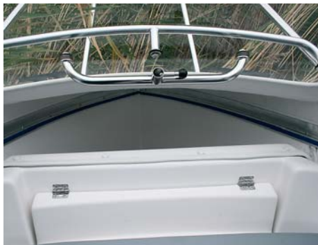
Система поручней для подъема стекла. В носу – открытый якорный ящик.
