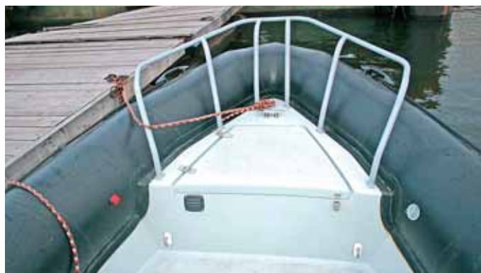
Мощный релинг над форпиком повышает безопасность в свежую погоду
