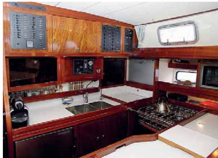
Камбуз: П-образное расположение поперек ДП позволяет удобно стоять на качке. Размещение распределительного щита – не самое лучшее
