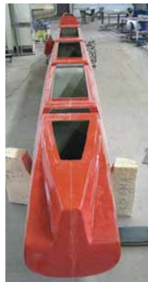
Поплавок разделен на 6 отсеков
