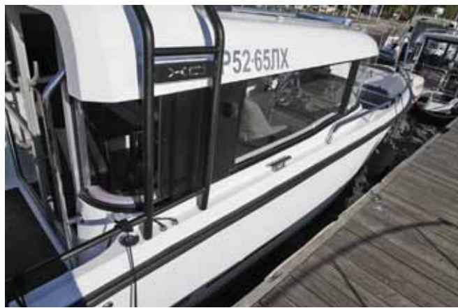
Планширь для прохода по борту не предназначен. Бортовая утка доступна только с бона
