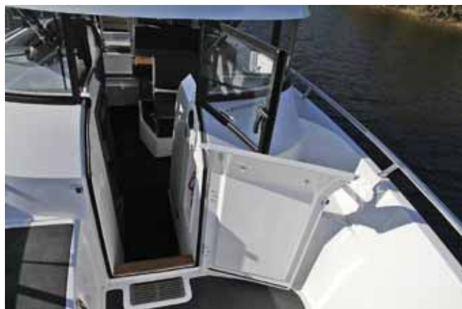
Носовая дверь рубки для лучшего уплотнения состоит из двух частей, закрепленных на жесткой подвеске
