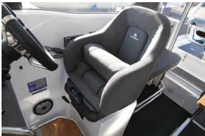
Только у водителя кресло снабжено подлокотниками и пневмоамортизатором
