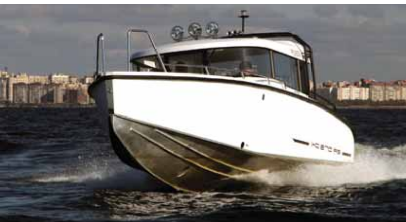
Высокая скула, вертикальный форштевень, запредельная килеватость – все для экстремального волнопронзания
