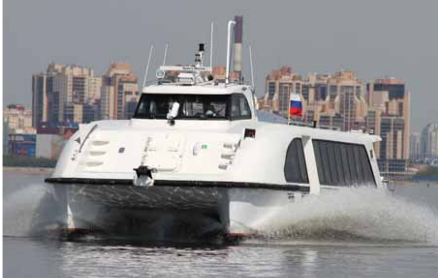
Рис. 5. Скоростной катамаран активно режет воду, но сидит глубоко – он не глиссирует
