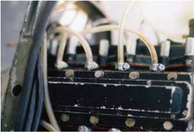
Первые испытания форкамеры на двигателе «Вихрь-45». Шланги – для проверки температуры воды в разных точках системы охлаждения глушителя
