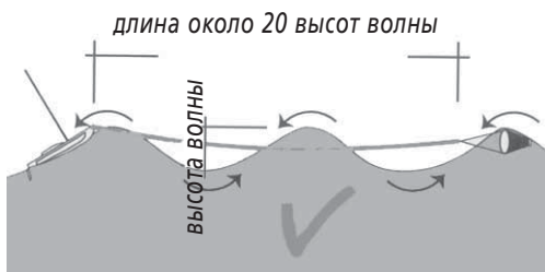
Правильное положение плавучего якоря
